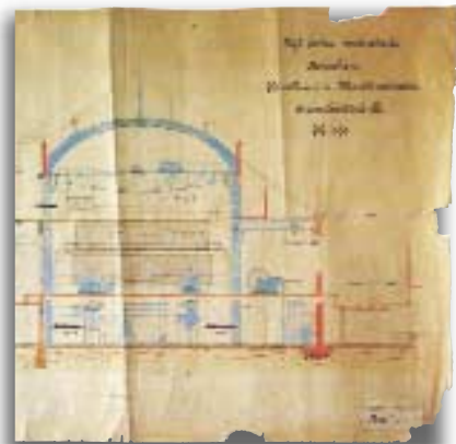
Technische Universität München Querschnitt Kesselhaus und Maschinenhalle
